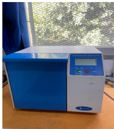
Figure 3 : Stomacher de type 400 CIRCULATOR
